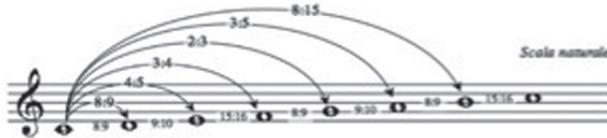
Nessuna delle frequenze delle 12 note del temperamento equabile corrisponde esattamente alle frequenze delle note della scala naturale, e tuttavia le note del temperamento equabile che corrispondono ai tasti bianchi del pianoforte (le note 1, 3, 5, 6, 7, 9, 11, 12) hanno frequenze che corrispondono con buona approssimazione a quelle della scala naturale (fig. 10).
