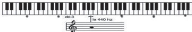
Tutti i tasti vengono tarati in modo che le note che essi emettono abbiano una fondamentale doppia della fondamentale del tasto corrispondente che li precede. Ad esempio per il tasto indicato con la freccia e per i suoi tasti corrispondenti (contrassegnati da un pallino), le frequenze di taratura sarebbero 110, 220, 440, 880, ... Hz.
