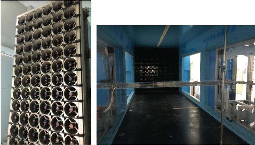
Figura 24. a) muro di ventole, alto 2.64 m e largo 1.32 m, della galleria multi-fan della Tamkang University, a Taipei; b) prisma a base quadrata disposto orizzontalmente nella galleria multi-fan.
