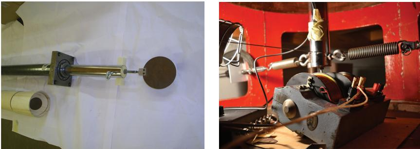
Figura 11. a) parte terminale del tubo di fibra di carbonio con connessione a un disco circolare di rame; b) particolare sotto al pavimento della galleria del vento.
