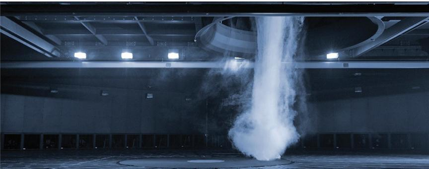
Figura 23. a) foto della camera del WindEEE; b) rilascio dalla bocca presente nel soffitto che viene visualizzato grazie alla presenza di fumo.
