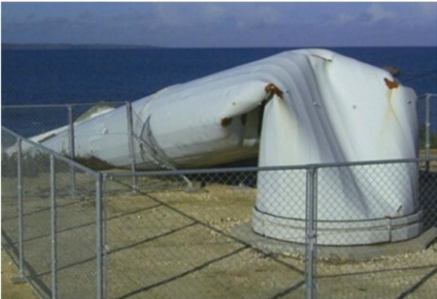
Figura 7. *Collasso per fatica di un palo circolare.*
