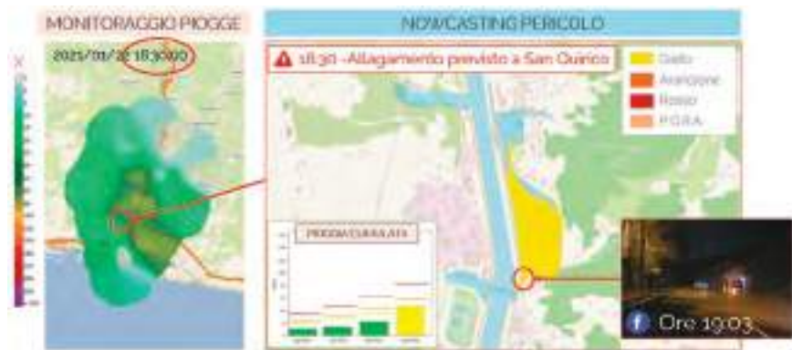
Figura 10. Bacino del torrente Polcevera: nel riquadro di sinistra è riportata la mappa di intensità di pioggia rilevata alle 18.30; nel riquadro in basso al centro sono rappresentate le barre dinamiche delle piogge cumulate a vari intervalli temporali, nella mappa grande sono riportate le fasce di esondabilità secondo il P.G.R.A. Nel riquadro in basso a destra è rappresentata una fotografia del voltino della ferrovia (identificato sulla mappa dal cerchietto rosso) scattata alle ore 19.03. Per gentile concessione di Artys, una divisione di Darts Engineering.
