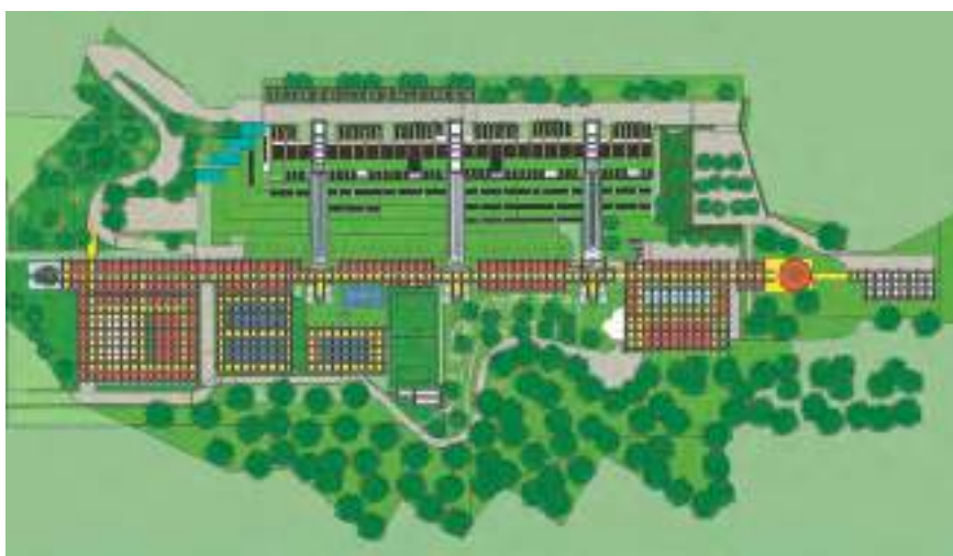
Figura 33. Ecoprogetto Campus Valle Puggia CUS Unige. Planimetria con strutture portanti a vista del nuovo CUS e Studentato, in rosso, i percorsi pedonali, in giallo, con asse urbanistico sud-ovest/nord-est tra scala giardino cilindrico e torre tecnologica; sopra, edificio universitario esistente Ziqqurat.
