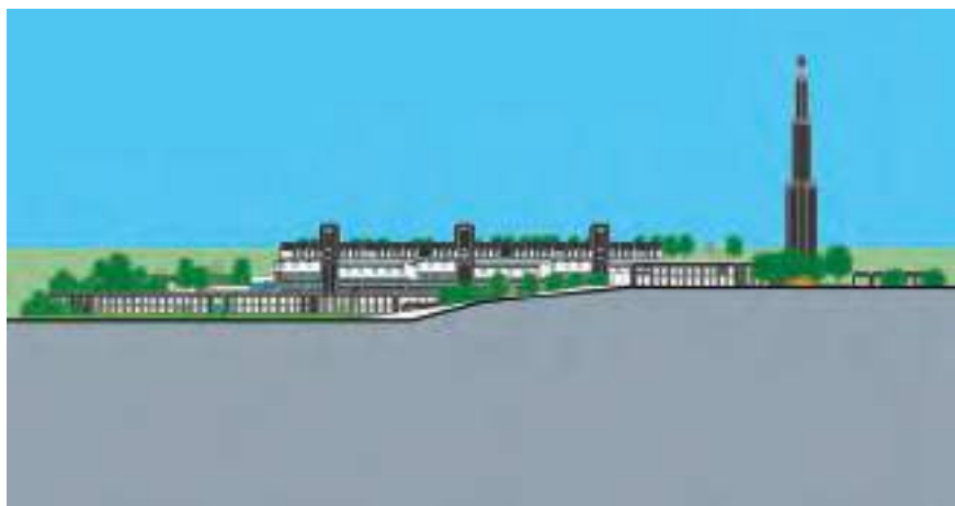
Figura 39. Ecoprogetto Campus Valle Puggia CUS Unige. Prospetto da est: in primo piano il nuovo CUS e Studentato, con asse urbanistico sud-ovest/nord-est tra scala giardino cilindrico e torre tecnologica in secondo piano; sopra, edificio esistente Ziqqurat.
