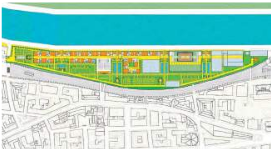
Figura 13. Ecoprogetto Certosa area Facchini. Planimetria del piano terreno del polo scolastico classico-digitale (dall'asilo nido e scuole elementari alla scuola media e liceo scientifico sperimentale). Il corridoio-strada interno costituisce l'asse urbanistico rettilineo e continuo, che distribuisce le aule, a due a due, dotate di servizi e di spazi per il verde scolastico e per la tecnologia didattica digitale.
