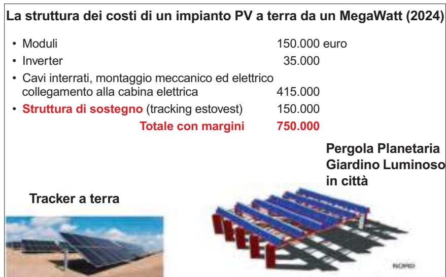
Figura 2. Esempio di struttura dei costi tipici e due principali sistemi impiantistici a terra o a pergola.
